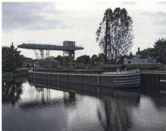
Finowmaßkahn: Länge 40,2 Meter; Breite 4,60 Meter; Tiefgang ca. 1,40 Meter; Tragfähigkeit 170 Tonnen. Das Finowmaß war das erste standardisierte Binnenschiffmaß. (Foto picasa)
