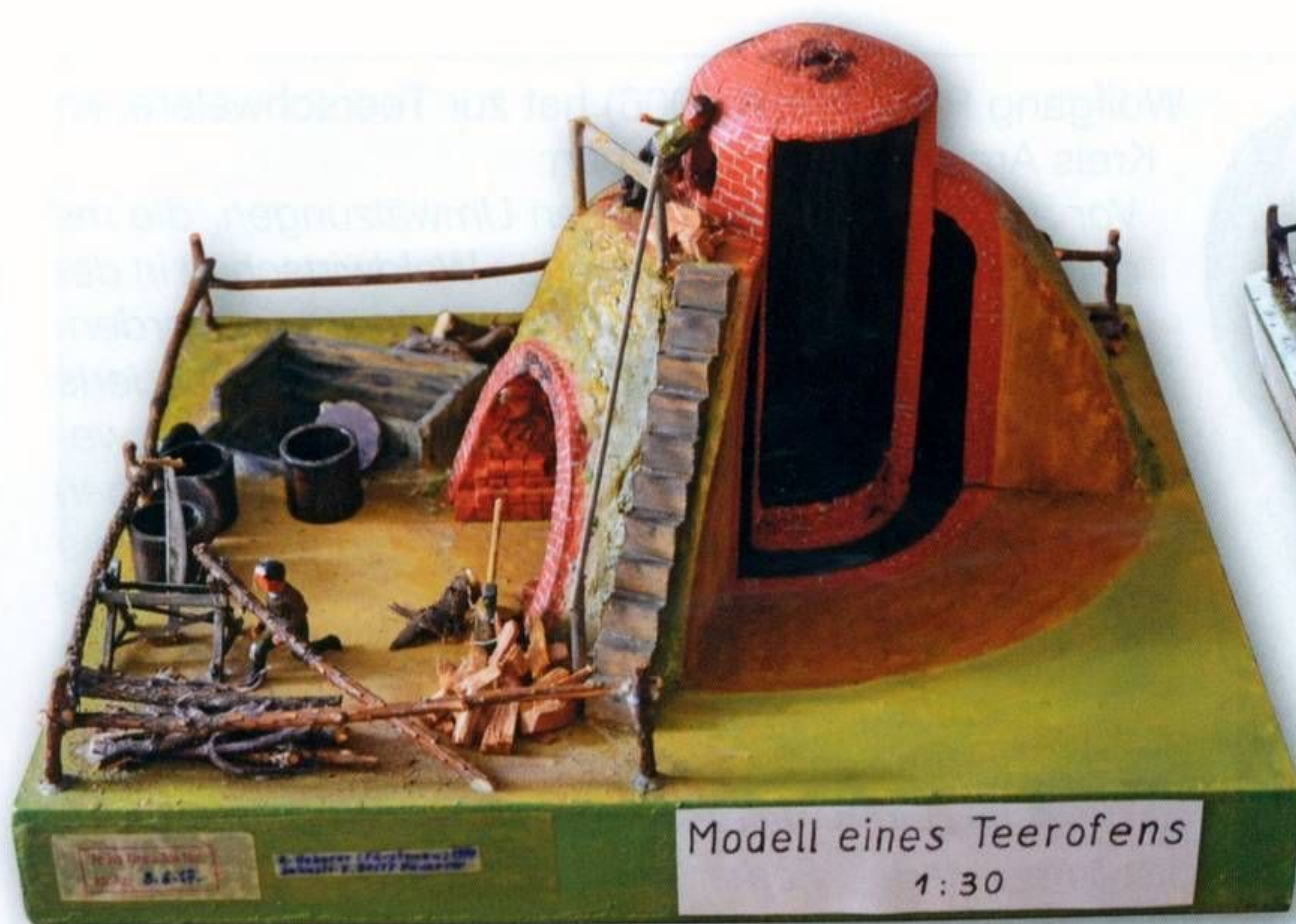
Modell eines „modernen“, gemauerten Teerofens, Maßstab ca. 1:30, gebaut von Kuno Heberer, Fürstenau, 1994. Links die Aufstieg- und Füllseite, rechts im Schnitt. (SB)
