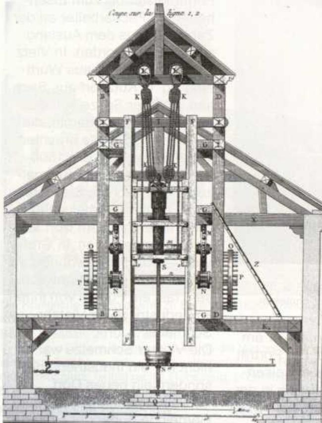
Bohren des Geschützrohres auf das gewünschte Kaliber - mit Hilfe eines Göpelwerks
